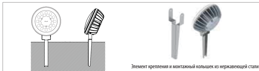
M 1: Установка при помощи колышка
