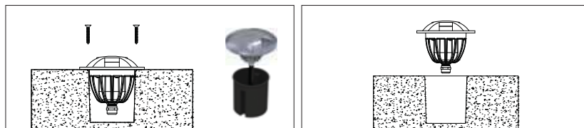
M V: Монтаж посредством привинчивания
