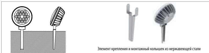
M 1: Установка при помощи колышка
