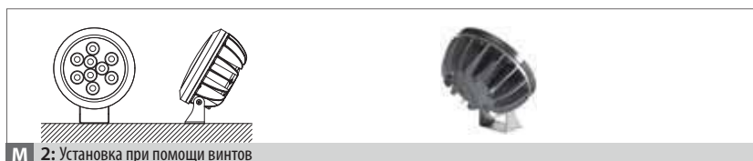
M 2: Установка при помощи винтов
