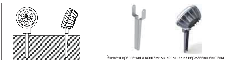
M 1: Установка посредством привинчивания
