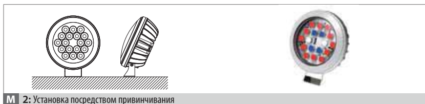
M 2: Установка посредством привинчивания
