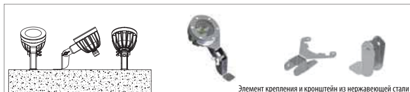
M 3: Установка посредством привинчивания
