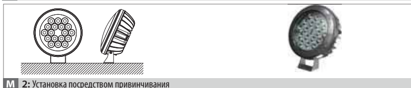
M 2: Установка посредством привинчивания
