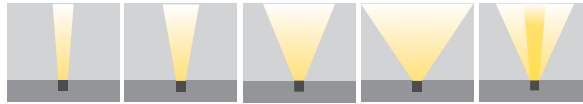
XN: Ekstra Dar Açılı N: Dar Açılı M: Orta Açılı W: Geniş Açılı E: Eliptik Açılı
