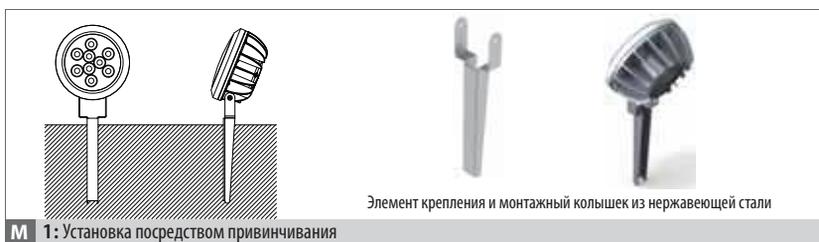
**M 1:** Установка посредством привинчивания
