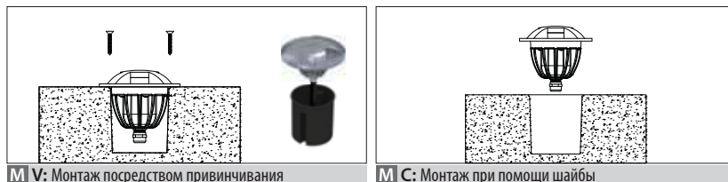
M V: Монтаж посредством привинчивания
